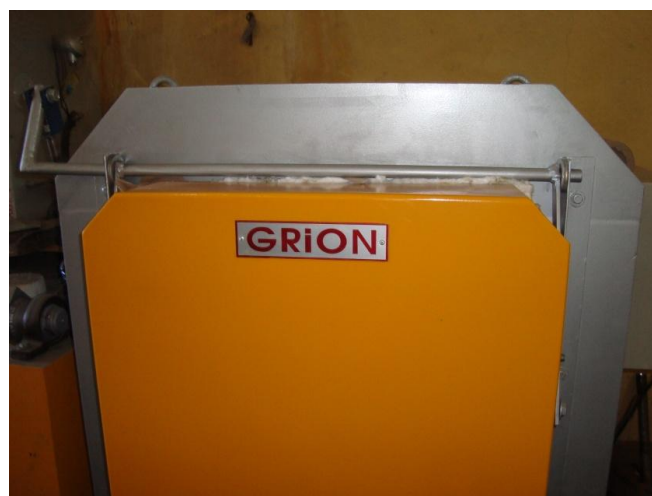
Figura 68 - Forno utilizado para aquecer a ferramenta de conformação superplástica
