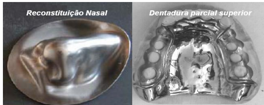
Figura 14 - Próteses conformadas superplasticamente
